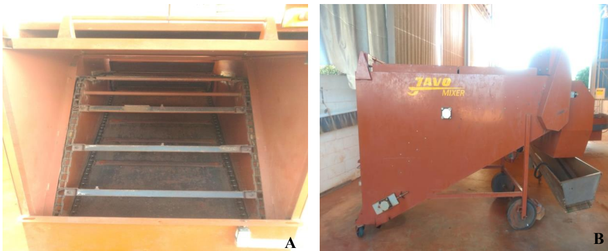
Figura 2. Equipamento homogeneizador de solo e substrato (A) Mixer visão interna (B) Mixer visão externa com esteira transportadora.
