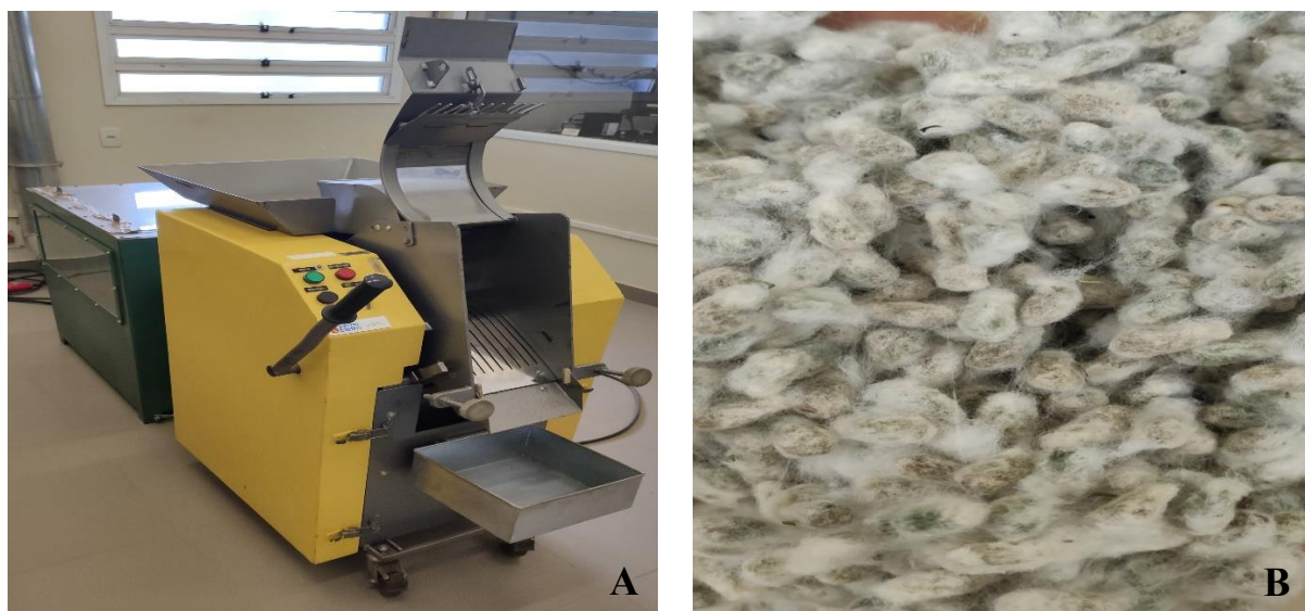
Figura 7. Processo de descaroçamento de algodão (A) Máquina de descaroçamento de algodão (B) Algodão em caroço com línter.
