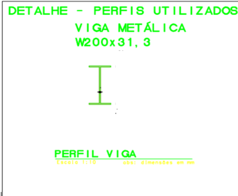
Figura 06: Detalhe Perfil I. Fonte: Autores
