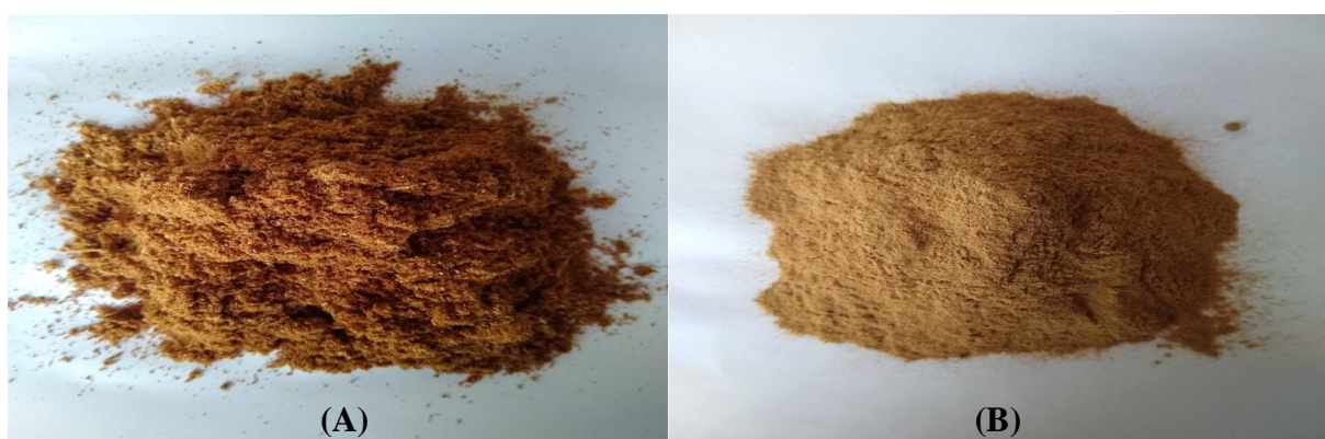
Figura 1. Comparação entre o pó de serra natural (A) e após sua moagem (B).
