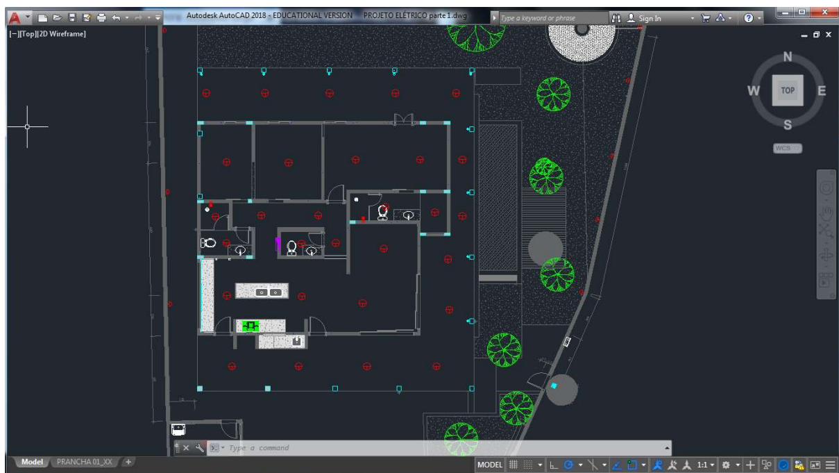
FIGURA 09: Lançamento dos pontos de iluminação na residência principal.
