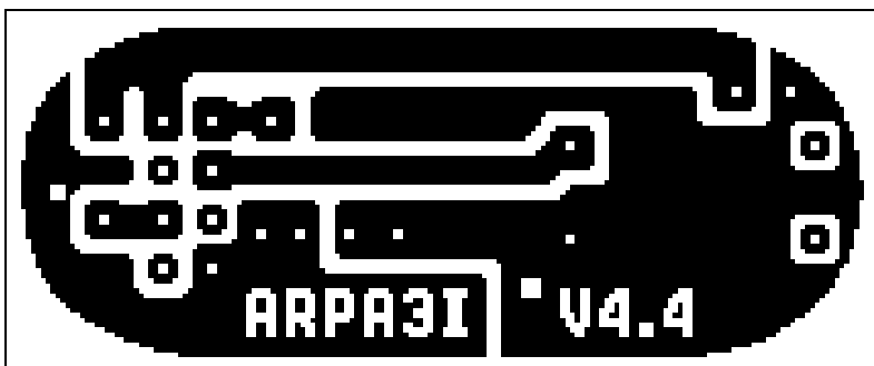
Figura 19. Projeto da PCB da Pulseira Assistiva. Fonte: Autoria própria.
