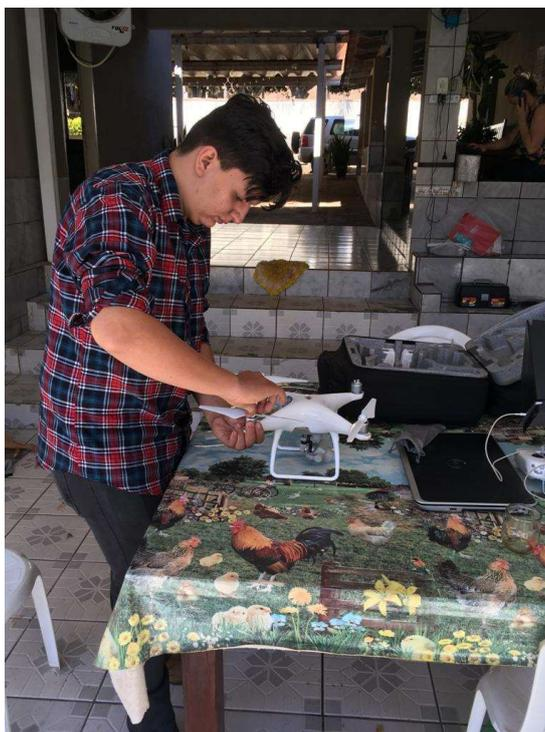
**Figura 6.** Montagem das hélices do Drone Phantom 4 Advanced.
