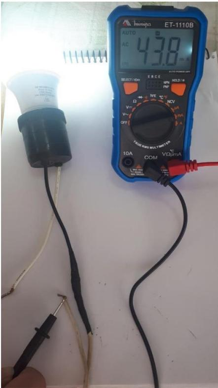
Figura 35-Leitura de Corrente Multímetro
