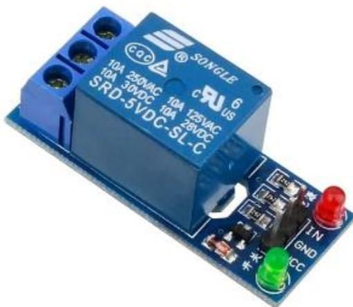
Figura 9-Modulo Relé 5V
