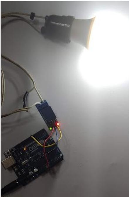
*Figura 31-Teste Relé Fechado*
