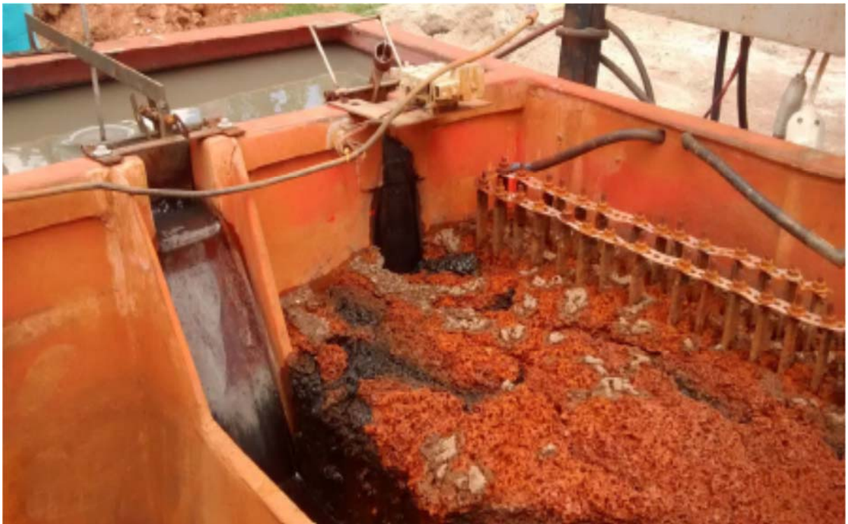
Figura 3. Detalhe da comporta de regularização de vazão de arraste do lodo flotado por eletrólise. Do lado direito, o lodo flotado. Fonte: Próprios Autores, 2018
