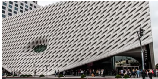
Figura 65 : Fachada Museu The Broad - GFRC (concreto reforçado com fibras de vidro). Autor : Archdaily, 2025.
