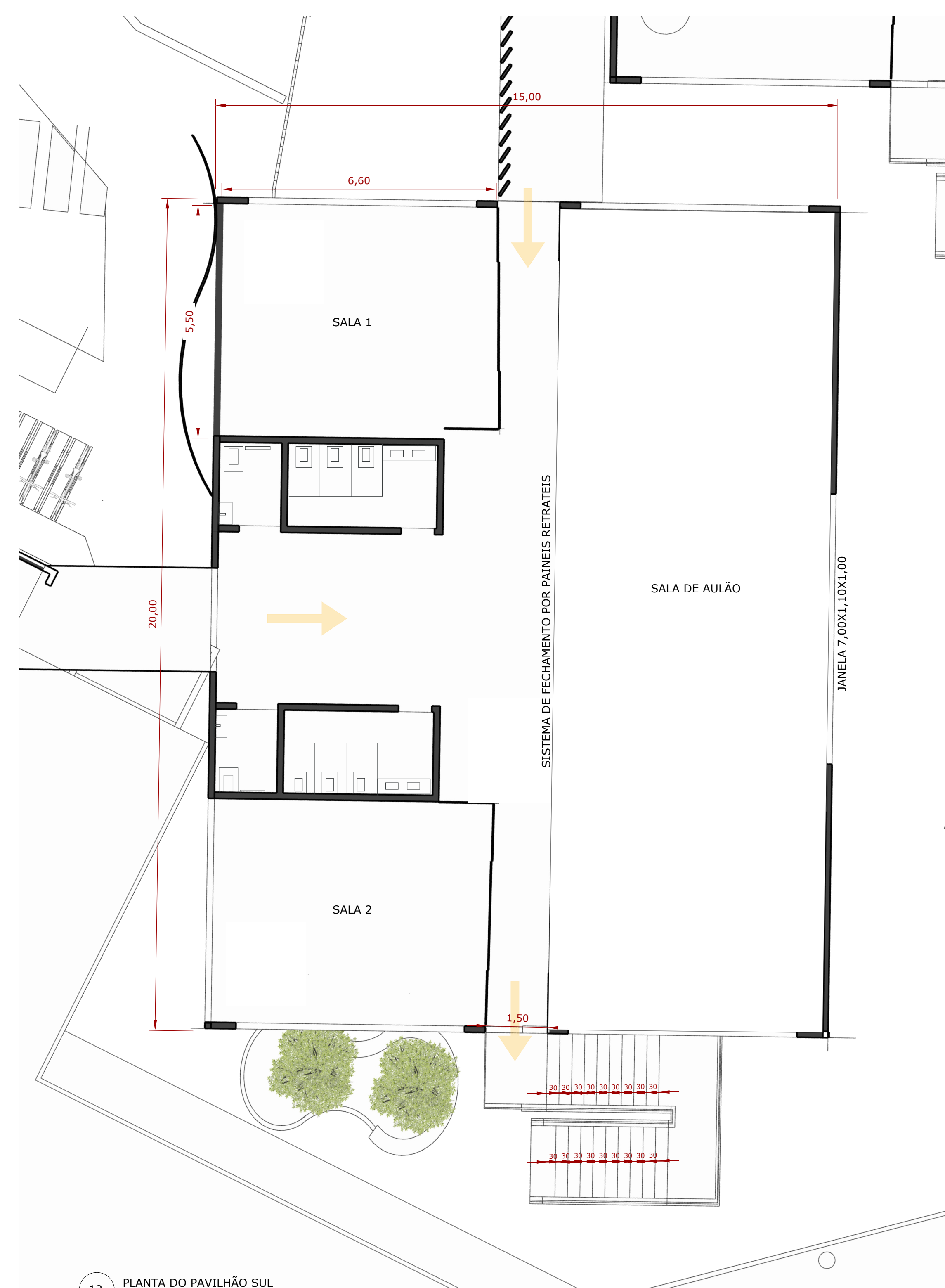
12 PLANTA DO PAVILHÃO SUL ESCALA 1:75
