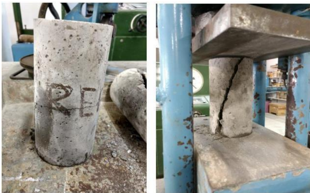
Figura 11 - Corpos de prova durante e após ensaio de resistência à compressão axial
