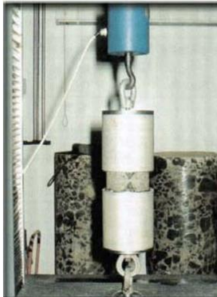
Figura 12 - Corpo de Prova Posicionado para Ensaio de Tração Direta
