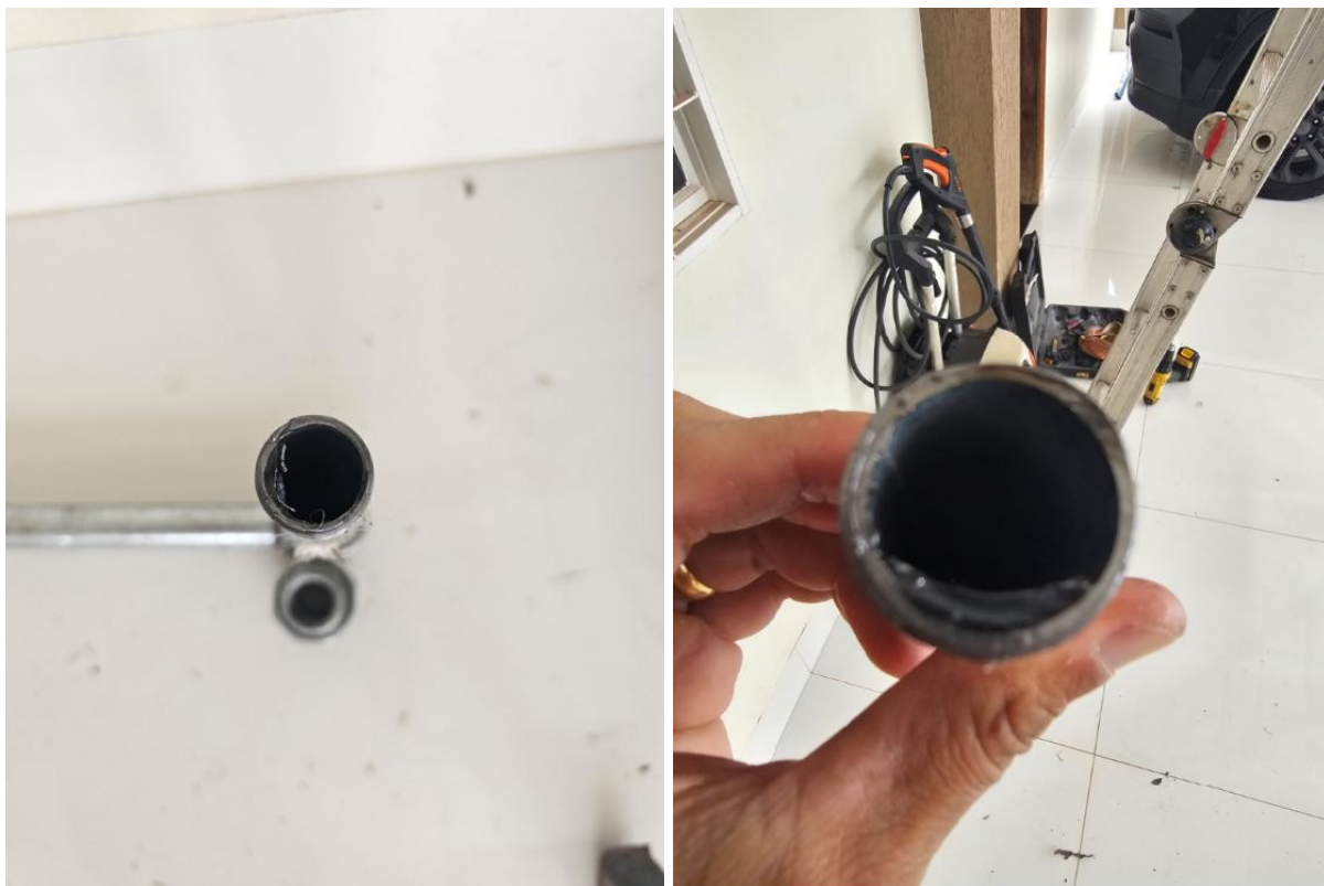
Figura 10: Tubos galvanizado com rebarbas. Figura 11: Tubos galvanizado com rebarbas.
