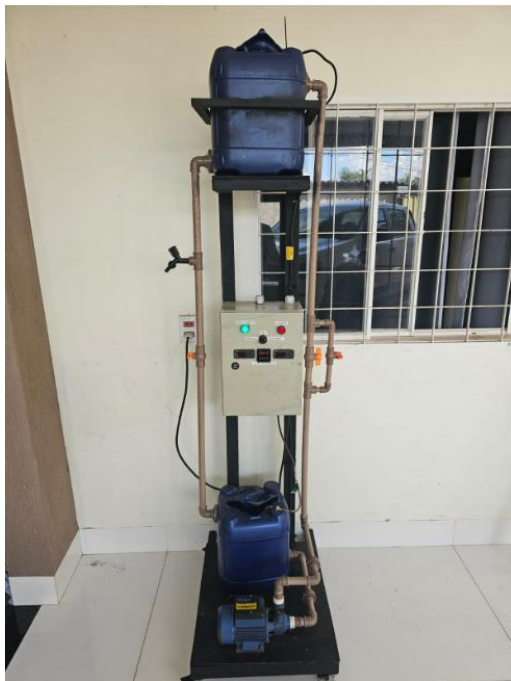
Figura 5: Protótipo dos reservatórios em Tubos PVC.
