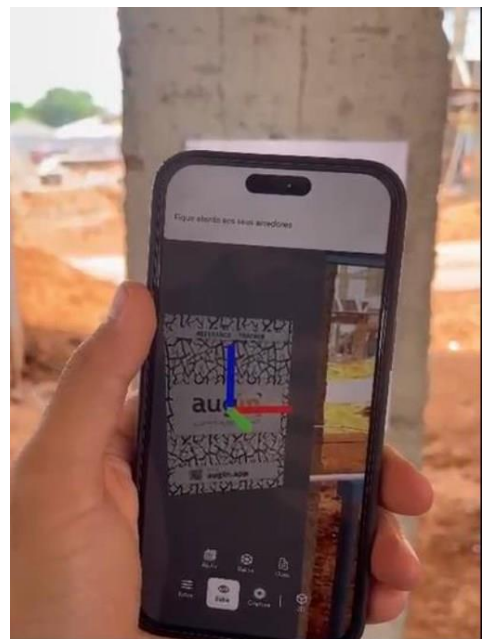
Fig. 08 – R.A com ponto de ancoragem
