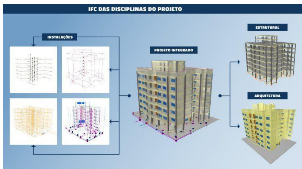
Figura 7: Modelo de projeto integrado em IFC
