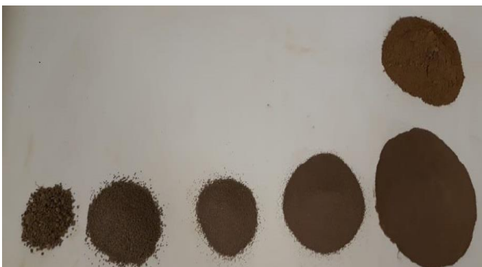
Figura 15. Ensaio de granulometria. Figura 16. Amostra retida em cada peneira.
