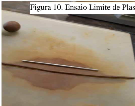
Figura 9. Ensaio Limite de Plasticidade.
