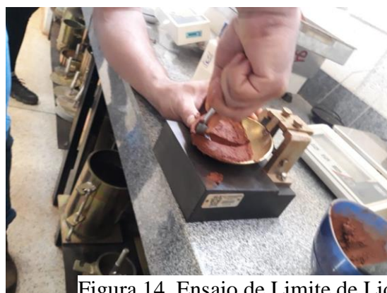
Figura 13. Ensaio de Limite de Liquidez.
