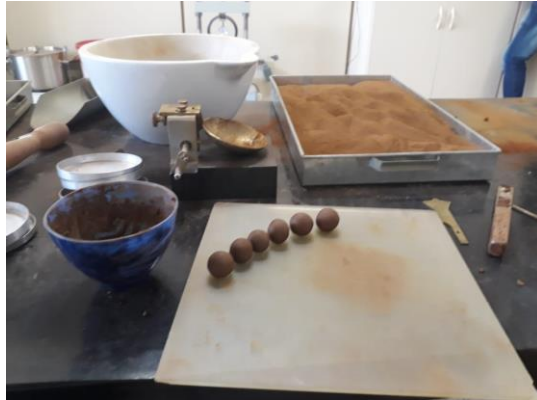
Figura 10. Ensaio Limite de Plasticidade.
