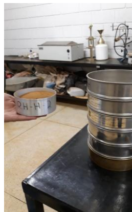
Figura 15. Ensaio de granulometria. Figura 16. Amostra retida em cada peneira.
