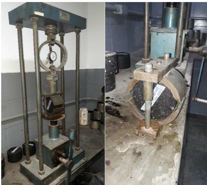
Figura 11. Prensa Marshall manual para rompimento dos corpos de prova. Fonte: Autoral (2018).
