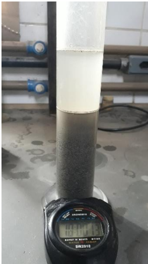
Figura 5. Equivalente de areia. Fonte: Autoral (2018).
