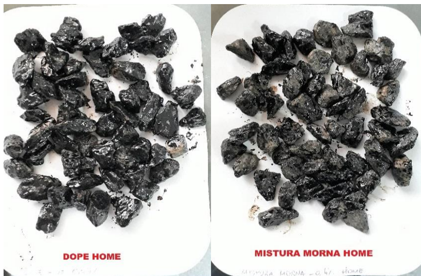
Figura 19. Resultados do ensaio de adesividade.
