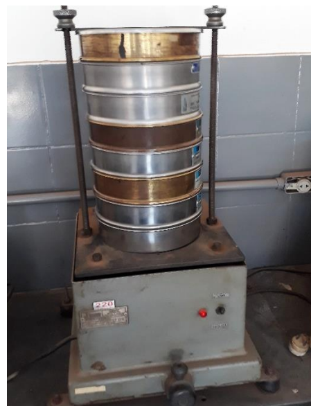
Figura 4. Peneiras para Ensaio de Granulometria. Fonte: Autoral (2018).
