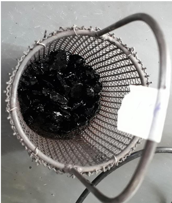
Figura 14. Agregado coberto por ligante. Fonte: Autoral (2018).
