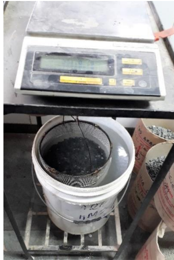
Figura 6. Densidade do agregado graúdo. Fonte: Autoral (2018).
