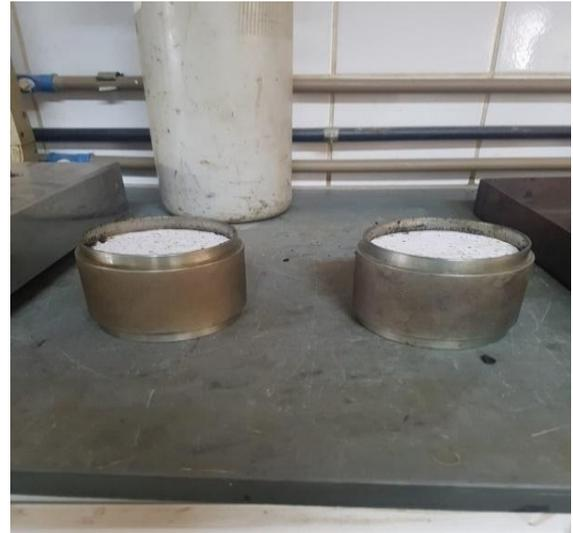
**Figura 6**: Corpos de Prova antes de desmoldar
