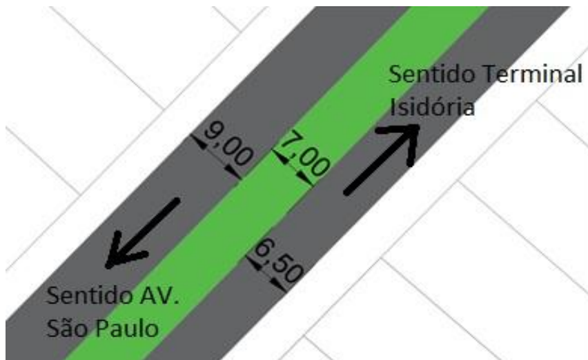
Figura 9: Imagem que demonstra as dimensões antes das obras do BRT. Organização: BORGES. M. M; CORREA. R.M (2018).
