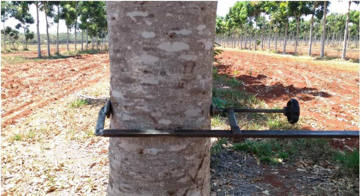
Figura 4. Ferramenta utilizada para medir o DAP, Nazário-GO, Setembro, 2018.
