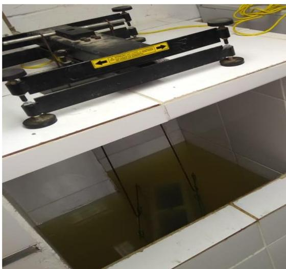
Figura 08: Ensaio de absorção dos blocos de concreto.
