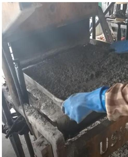
Figura 05: Traço de concreto colocado na maquina de blocos.
