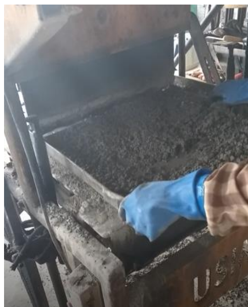
Figura 05: Traço de concreto colocado na máquina de blocos.
