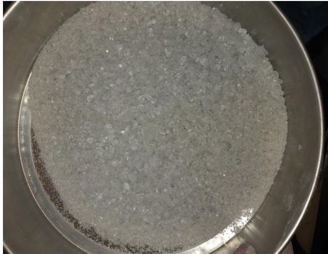
Figura 03: Pó de vidro temperado que passou pela peneira de abertura 4,75mm.
