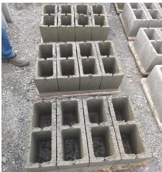
Figura 07: Inspeção visual dos blocos de concreto fabricados com pó de vidro.
