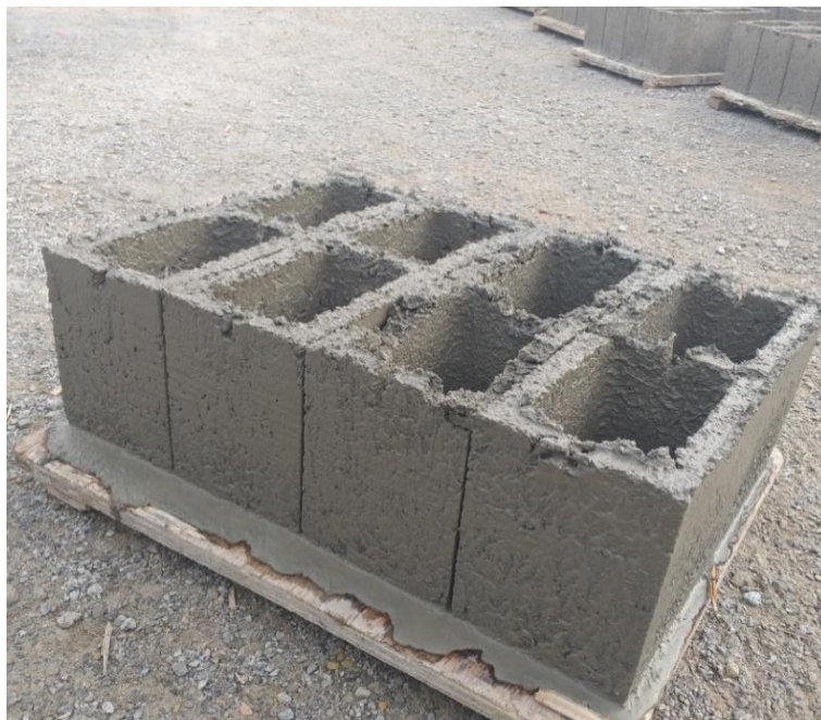
Figura 06: Bloco de concreto com a adição de 10% de pó de vidro temperado.
