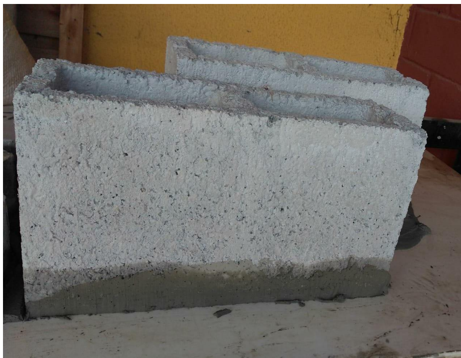
Figura 10: Bloco capeado para ensaio de resistência à compressão
