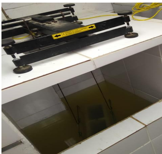
Figura 08: Ensaio de absorção dos blocos de concreto.
