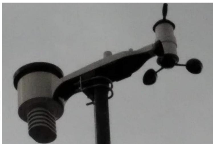
Figura 1. Estação Meteorológica Profissional WT1081.
