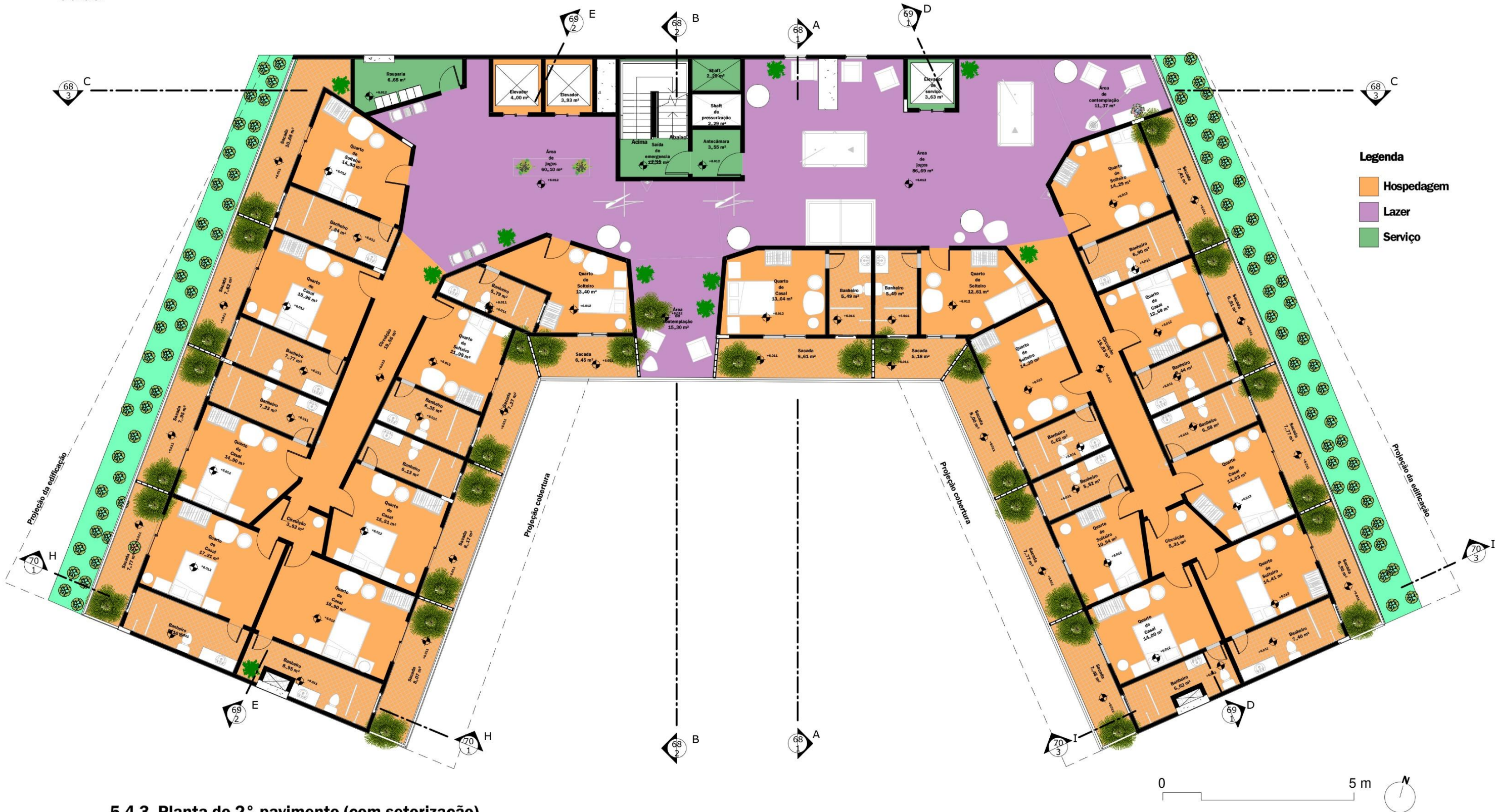
5.4.3. Planta do 2º pavimento (com setorização) Esc: 1/150
