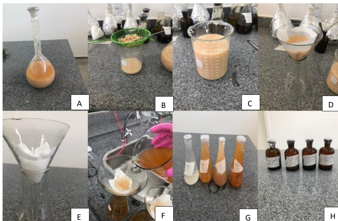
Figura 6: Processo de filtração do extrato alcoólico de alho: extrato pronto após armazenagem (A); primeira filtração em peneira (B); extrato após primeira filtração (C); segunda filtração em papel de filtro (D); materiais para terceira filtração, dupla camada de 18
