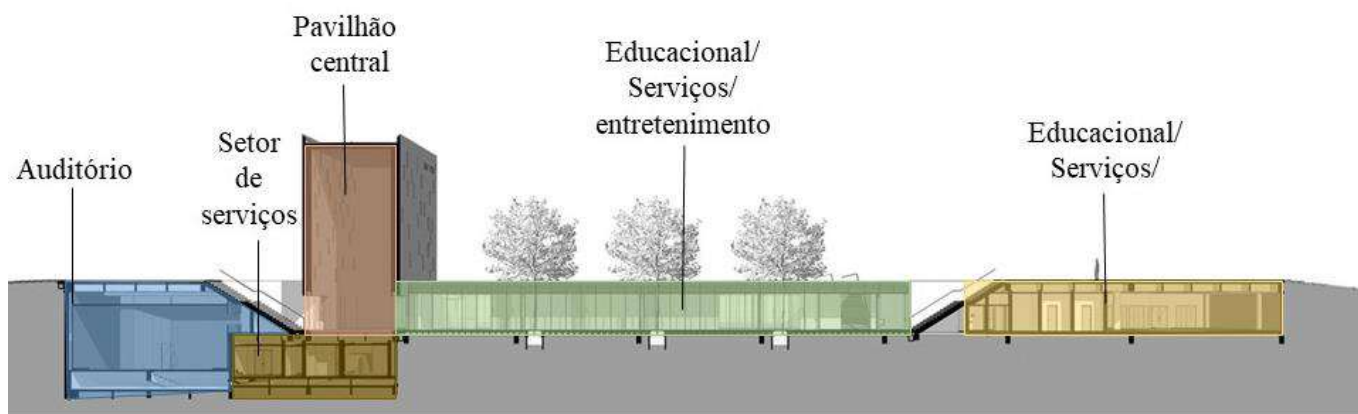
Figura 06: Corte do edifício, análise funcional.
