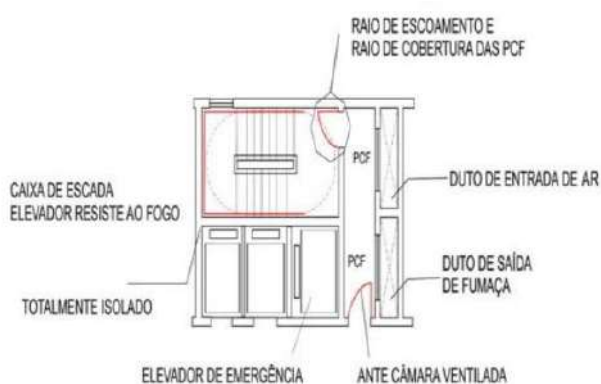
Figura 57: Escada de segurança. Fonte: Norma técnica 02/2014, 2018 modificado por Kálita Lorrane.
