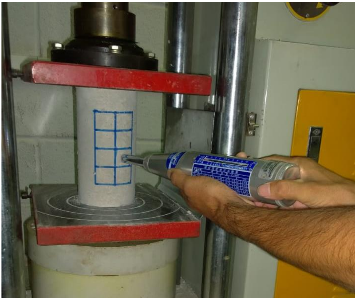
Figura 1 - Esclerometria em corpo de prova apoiado em prensa hidráulica com carga de 1MPa.
