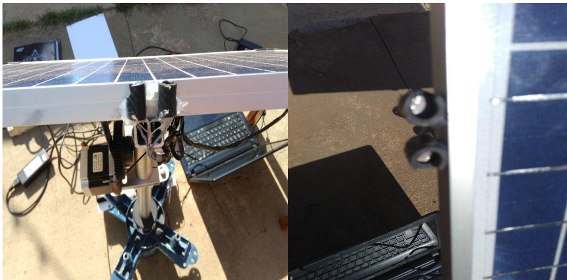
Figura 19. Sensores LDRs implementados no sistema.
