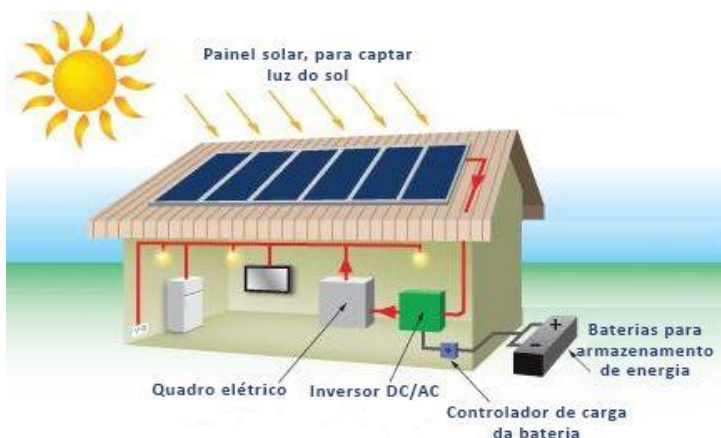
Figura 2. Sistema fotovoltaico autônomo com armazenamento de caga ( off-grid ).
