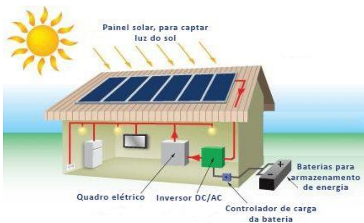
Figura 2. Sistema fotovoltaico autônomo com armazenamento de energia ( off-grid ). Fonte: Bluesol, 2019.
