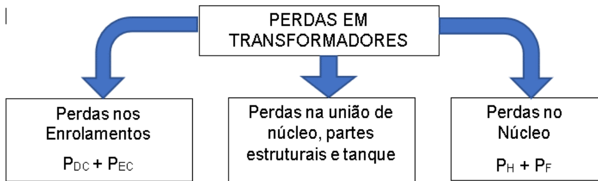
Figura 2. Visão geral das perdas nos transformadores.
