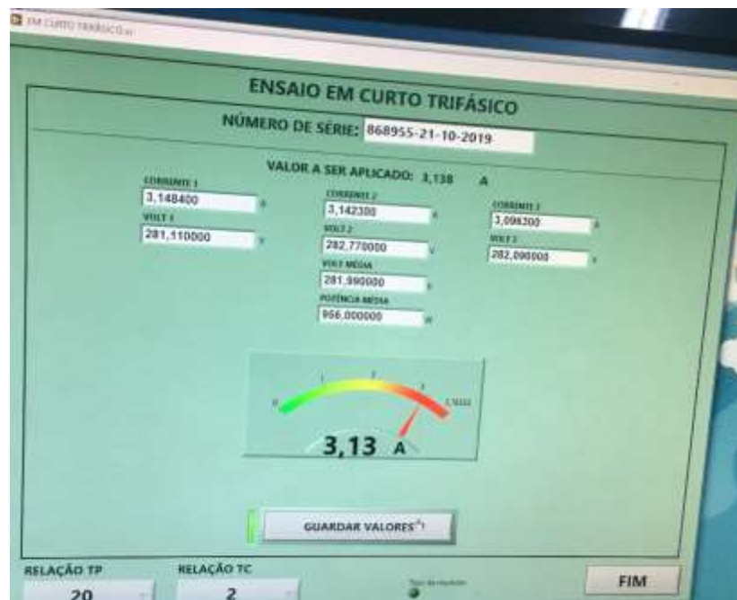
Figura 7. Dados gerados no ensaio em curto-circuito.
