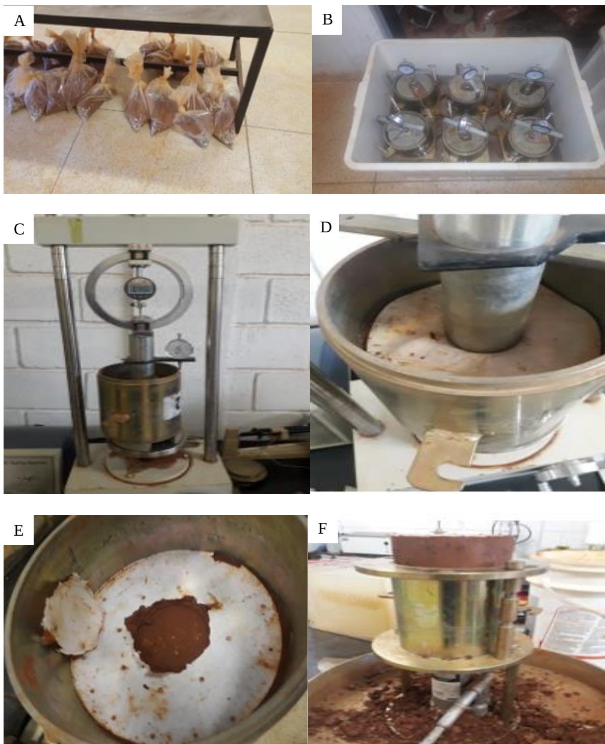
Figura 07: (A) Amostras preparadas e pesadas. (B) Corpo de prova compactados, imerso em água com extensômetros. (C) Cilindro na prensa. (D) Cilindro recebendo a penetração do aparelho. (E) Corpo de prova com a marca de penetração. (F) Desmolde do corpo de prova.
