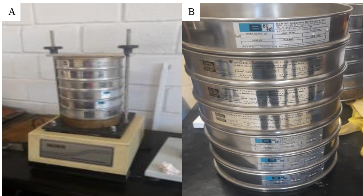
Figura 03: (A) Agitador mecânico. (B) Jogos de peneiras.
