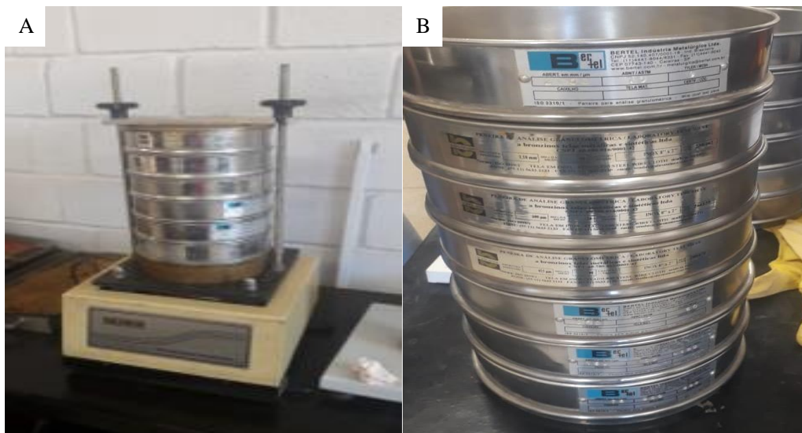
Figura 03: (A) Agitador mecânico. (B) Jogos de peneiras.
