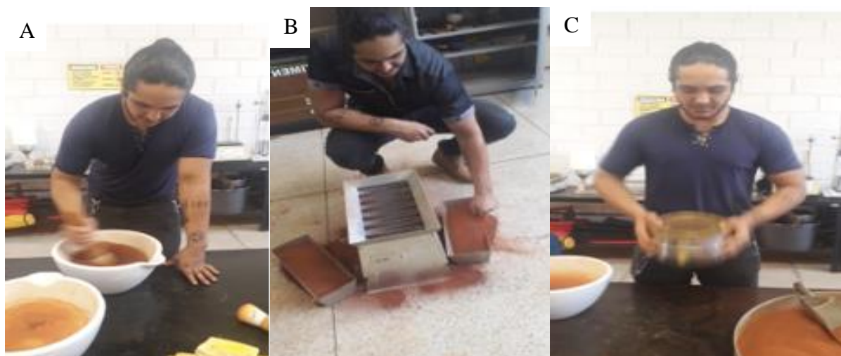
Figura 02: Preparação da amostra (A) Destorroamento. (B) Quarteamento. (C) Peneiramento.
