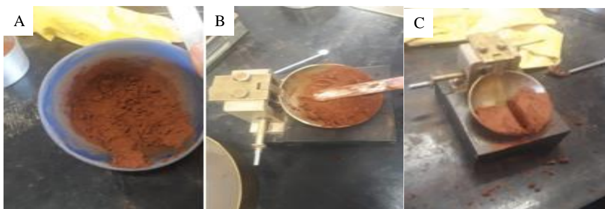
Figura 04: Ensaio de Limite de Liquidez. (A) Homogeneização da amostra. (B) Moldagem do solo na concha do aparelho Casagrande. (C) Realização da ranhura.
