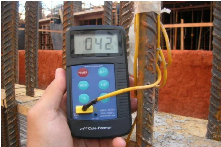
Figura 8 - Medição de temperatura com fios termopares.
