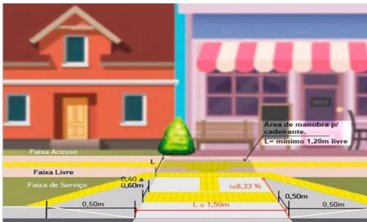
Figura 8: Parâmetros das Rampas de Acesso de Pedestre.
