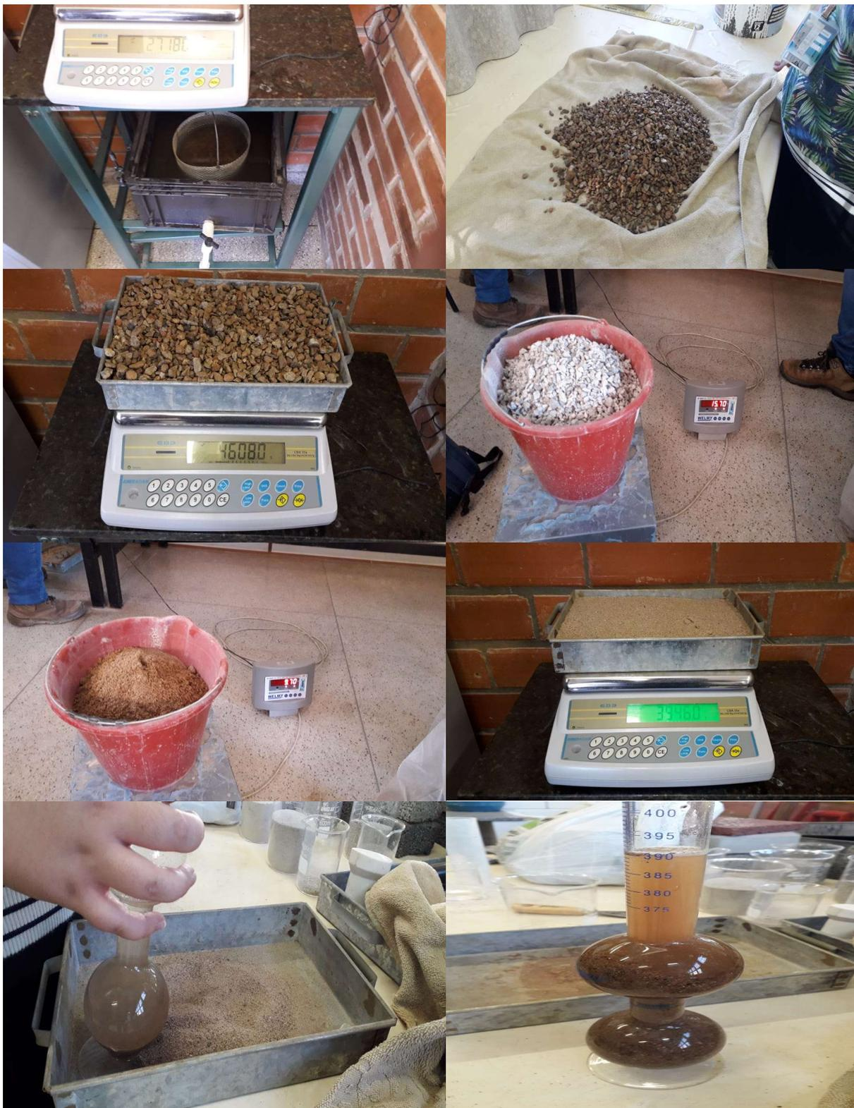
Figura C1. Determinação das massas específicas.
