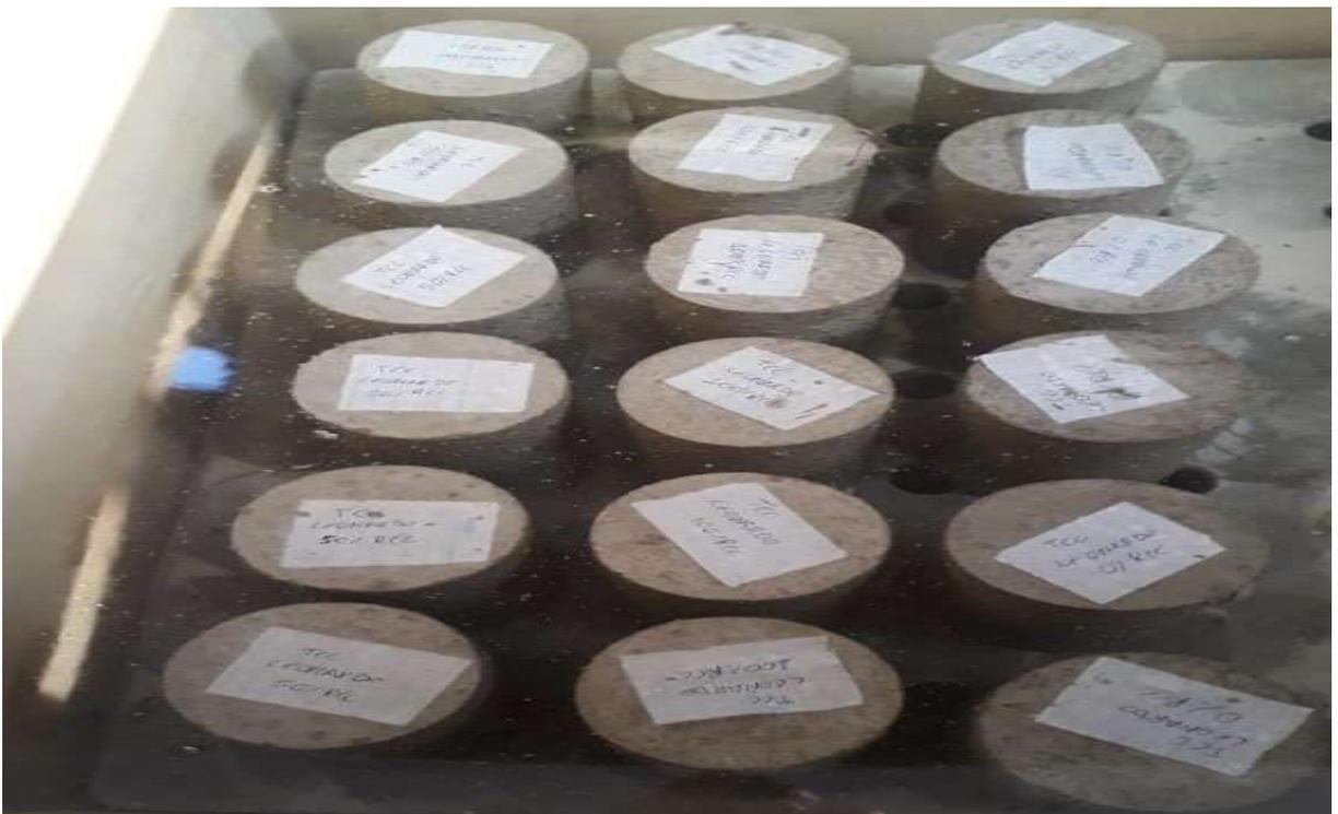
Figura 4. Cura úmida dos corpos de provas.
