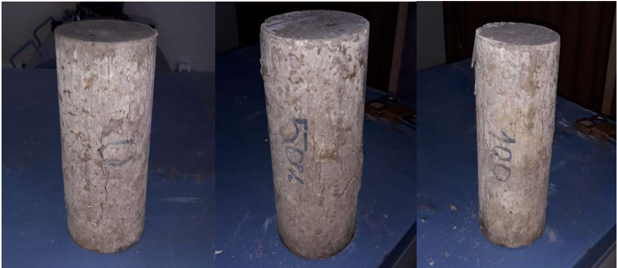
Figura 5. Corpos de provas rompidos nas idades 7,21 e 28 dias.
