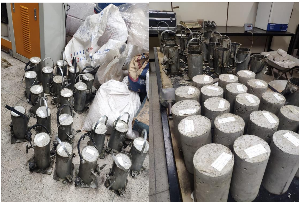
Figura 13: Corpos de provas no tempo de cura inicial e após o desmolde.
