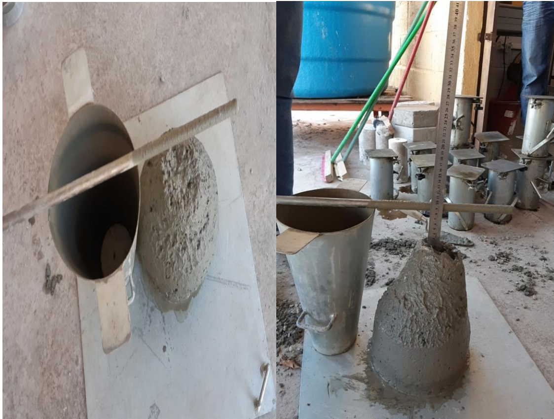
Figura 12: Ensaio Slump Test
