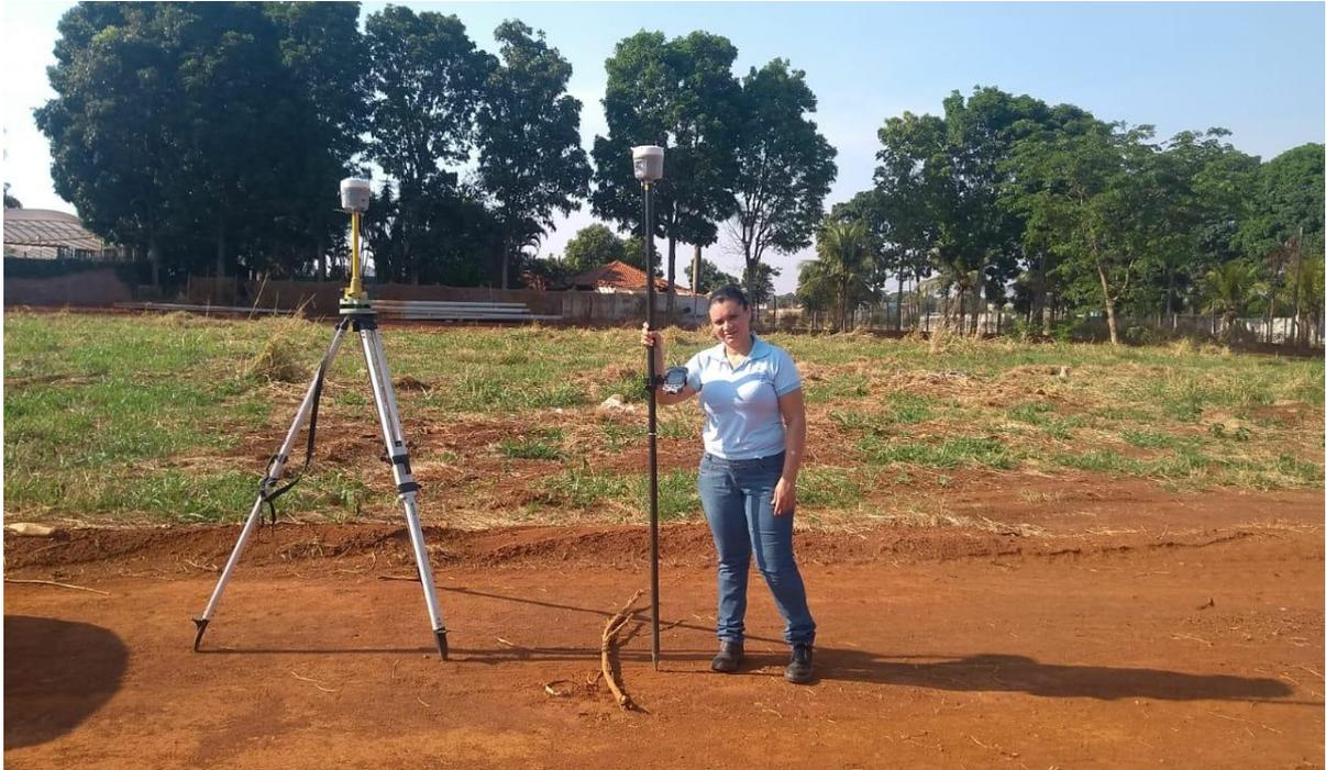
Figura 02. Levantamento topográfico com RTK.
