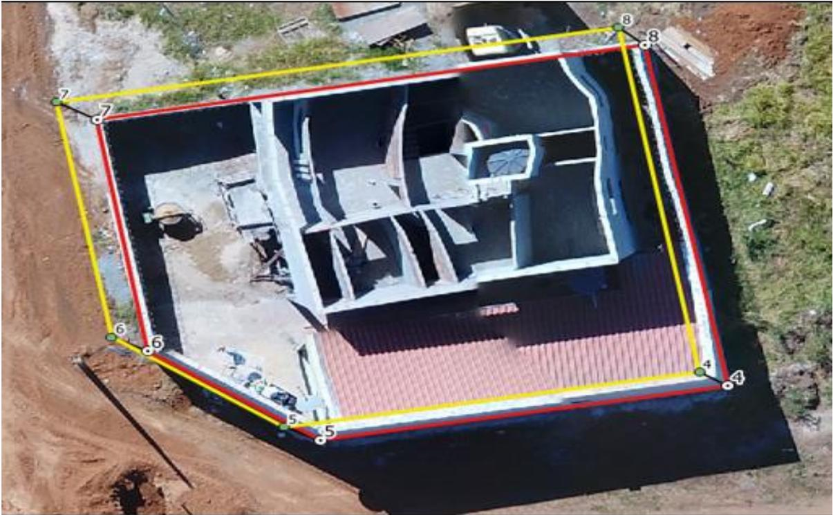
Figura 12. Polígono com indicação da área do RTK, sobrepondo a ortofoto gerada.
