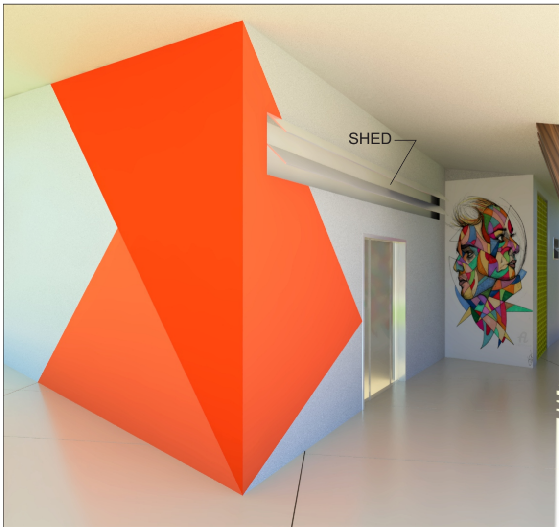
Figura 100: Ventilação por SHED.
