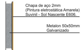
Fixação da chapa metálica na estrutura galvanizada acontecerá por arrebites com espaçamentos de 150mm entre eixos.
