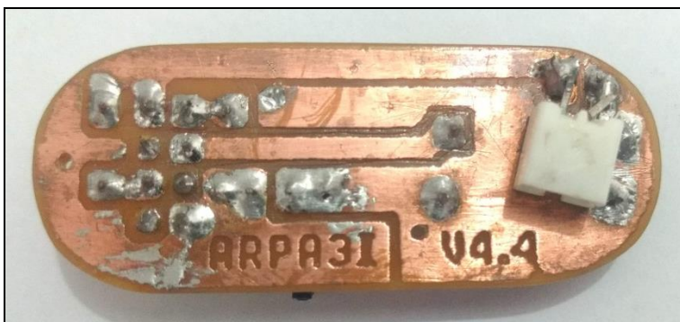
Figura 20. PCB da Pulseira Assistiva finalizada. Fonte: Autoria própria.
