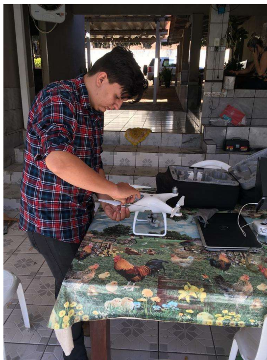
Figura 6. Montagem das hélices do Drone Phantom 4 Advanced. Fonte: Autor (2020)
