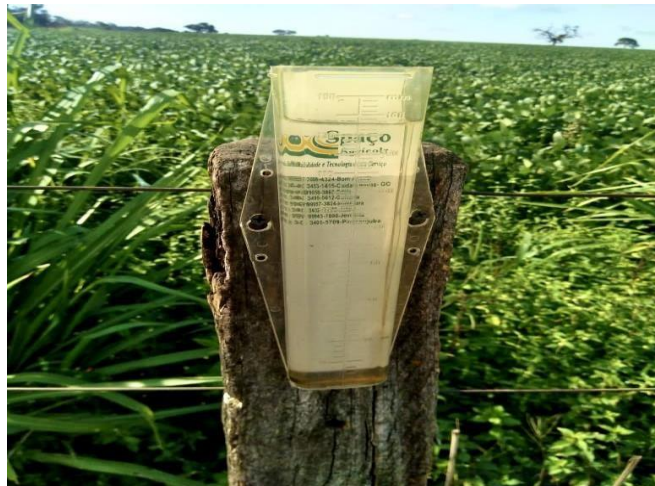
Figura 7 - Pluviômetro para monitoramento de precipitações na área de estudo.
