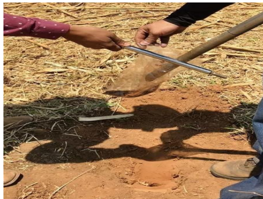
Figura 5 - Coleta de amostra de solo na área de estudo com a utilização do equipamento trado.
