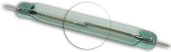
Figura 22-Dentro do Reed Switch
