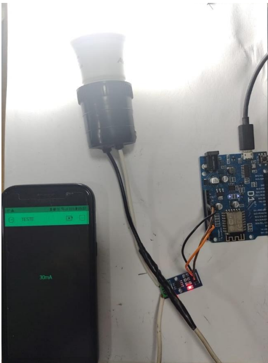
Figura 49-Leitura Blynk com corrente Fonte: Própria
