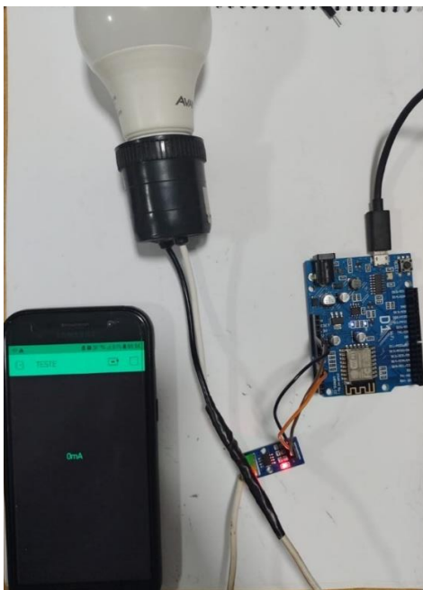
Figura 48-Leitura Blynk sem corrente Fonte: Própria
