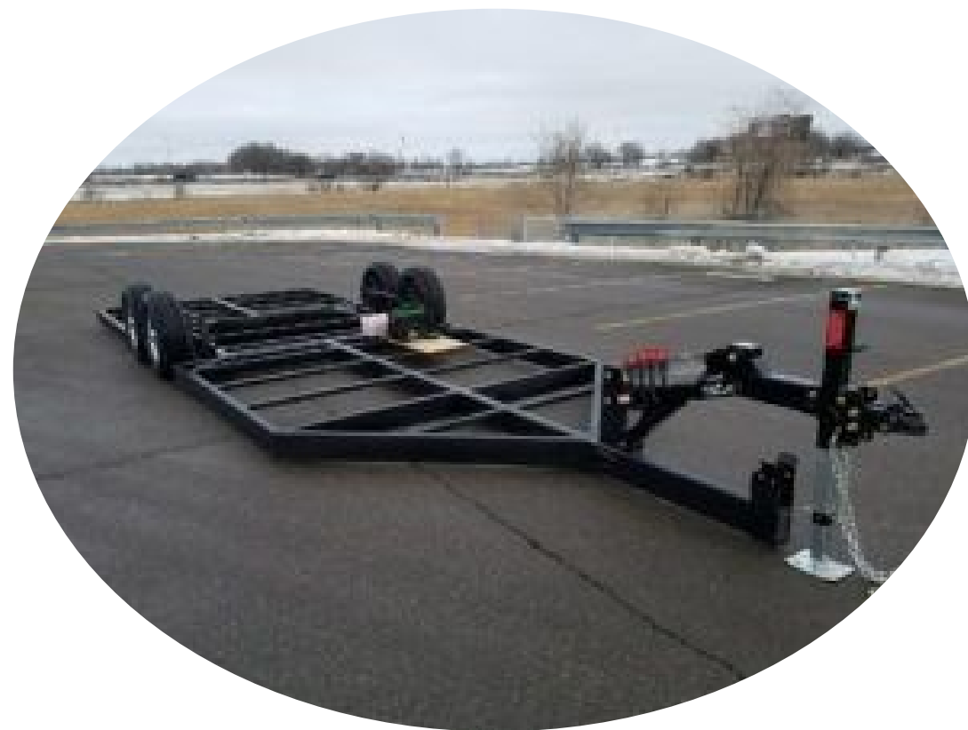
Figura 67 – Exemplo de estruturas de reboque com manivela e hidráulica com tecnologia de rebaixamento. Fonte: Pinterest, 2022
