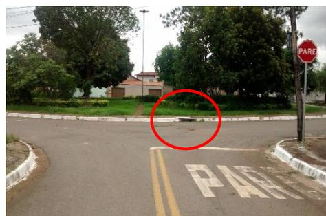
Figura 11. Bocas de lobo locada de forma ineficiente.
