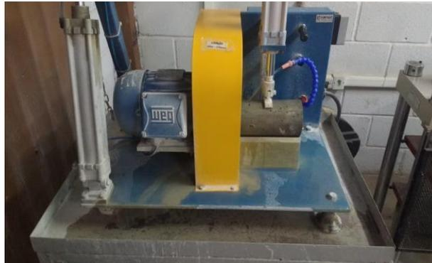
Figura 4 - retífica dos corpos de prova.
