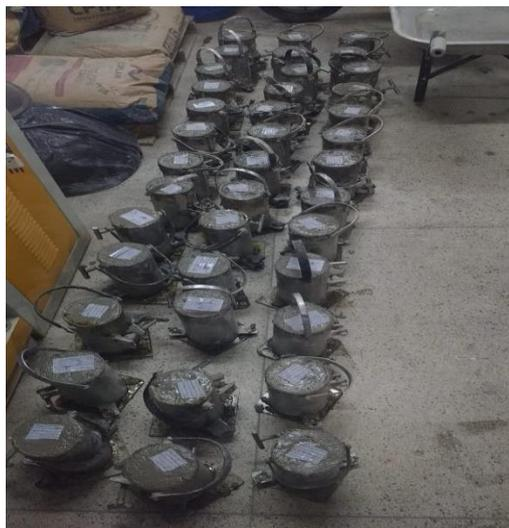
Figura 3 - moldagem dos corpos de prova.
