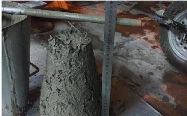
Figura 2 - Determinação do abatimento do concreto "Slump Test".
