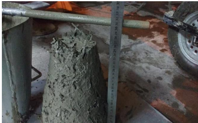
Figura 2 - Determinação do abatimento do concreto "Slump Test".
