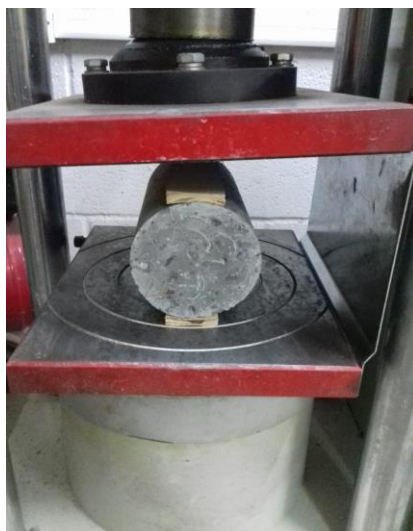
Figura 7 - ensaio de resistência à tração por compressão diametral.
