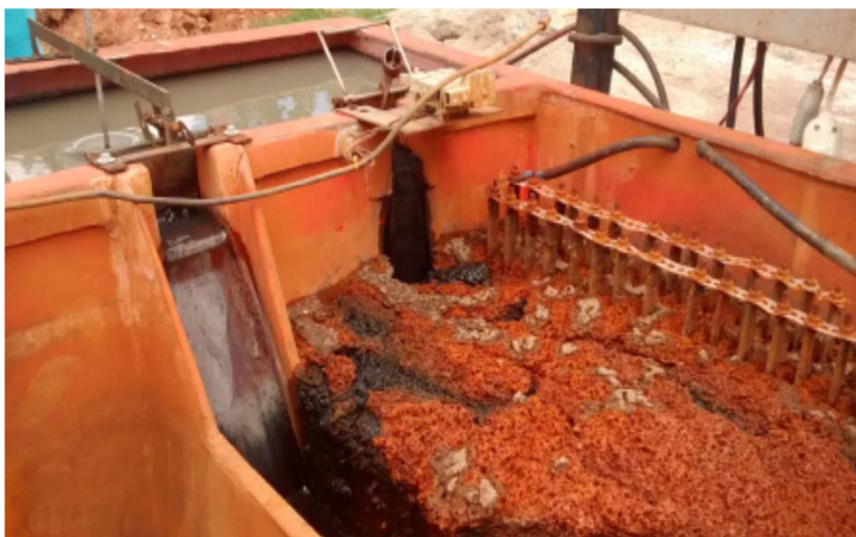
Figura 3. Detalhe da comporta de regularização de vazão de arraste do lodo flotado por eletrólise. Do lado direito, o lodo flotado. Fonte: Próprios Autores, 2018
