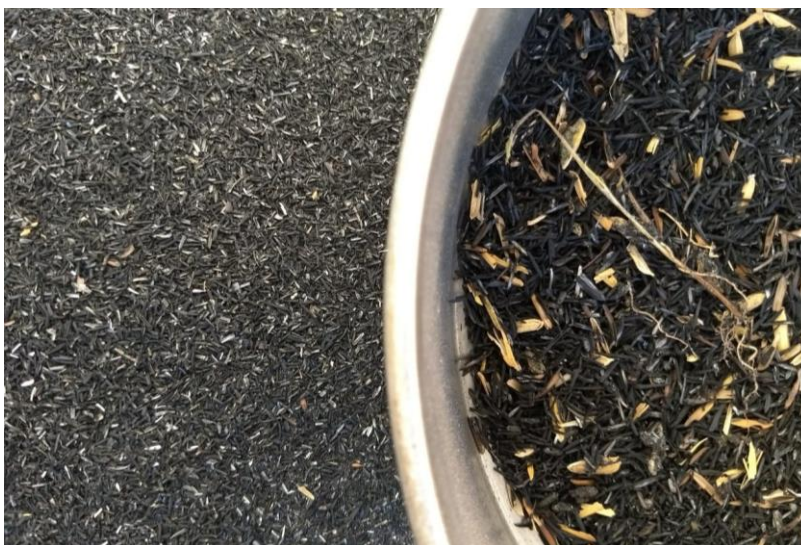
Figura 2 – Peneiramento da cinza da casca de arroz natural
